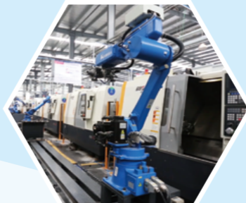
JR系列轮毂法兰盘机加工
