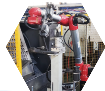
BR系列法兰盘 磨床自动化上下料
