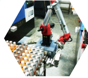
BR系列应用于麦克风配件机床自动化加工
